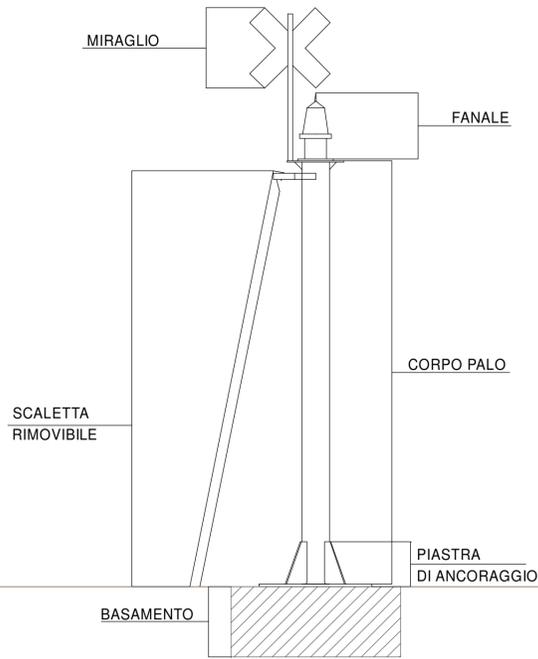
DETTAGLIO PIASTRA DI ANCORAGGIO SEGNALAMENTO A TERRA
